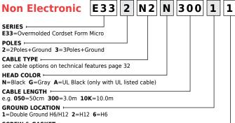
SCREW & GASKET + 1=Profile NBR Gasket & Screw, 2=Flat NBR Gasket & Screw
